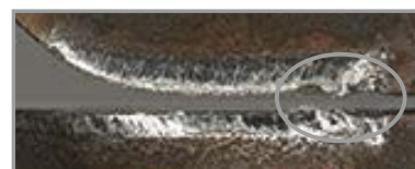
Filo de corte dañado
